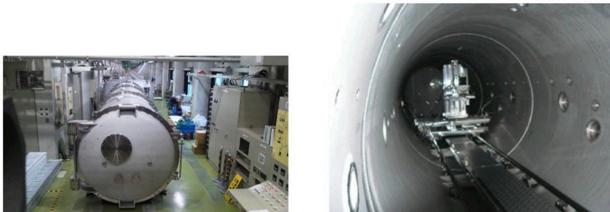
図 4.15: 左：ビームライン最下流から見た測定チャンバーの外観。右：チャンバー上流側のドアから下流側に見たチャンバー内部。
