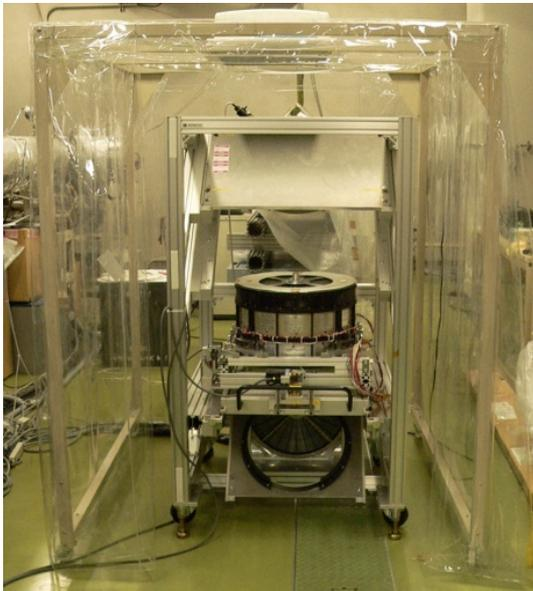
図 5.19: 折り返し光学系の高さを調整する。地面から反射鏡中心までの高さは約 140 cm。
