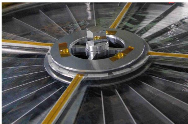
図 5.1: Top 側に付けられているキューブミラー。写真上方向の面がキューブミラーの法線（衛星  $z$  軸）。
