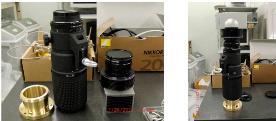
図 4.4: 左 : 右から順番に BITRAN BS-42N CCD カメラ、NIKON Ai AF Micro-Nikkor レンズ、レンズと望遠鏡に固定するための治具。右 : くみ上げた様子。各接続部はアルルダイトで固着している。
