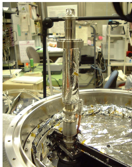
図 3.5: 液体ヘリウム注入口及びタワーの外観。 中央に巻いているのは熱制御フィルム。
