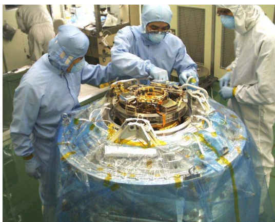
図 1.4: ASTRO-E に搭載された半導体カロリメータ (XRS) 用 ADR。中央の He insert の中に ADR の中心部となる salt pill がある。
