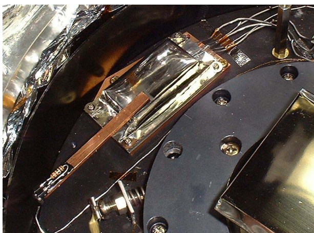
図 7.15: 導入した Nb の自作 shield。0.1mm 厚。銅の棒をエポキシ接着し、金属皮膜抵抗をヒーターとして取り付けている。
