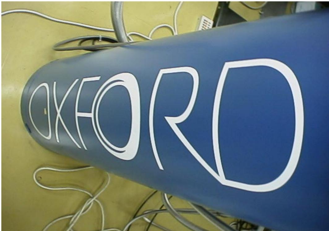
Figure D.1: 希釈冷凍機のデュワー部
