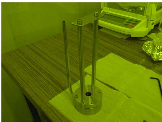
図 5.23: KOH エッチング用治具を組み立てたところ
