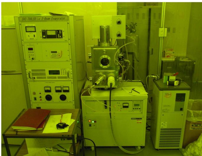
図 5.18: EB 蒸着装置
