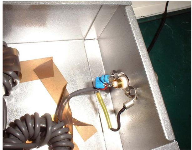
図 3.9: コモンモードフィルタ BOX 内部
