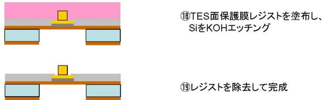
図 5.4: KOH エッチングのプロセスフロー
