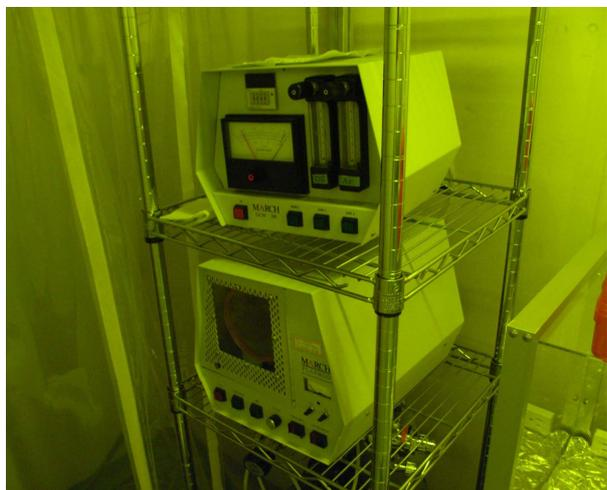
図 5.28: アッシャー。上段がコントローラーで下段に真空槽が置かれている。
