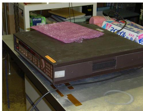
図 4.2: コイルの電源装置
