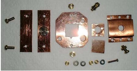
Fig. 6.1: 線源コリメータ固定金具のパーツ
