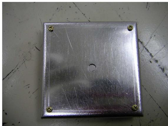
図 6.3: detector table に導入した X 線入射窓の様子
