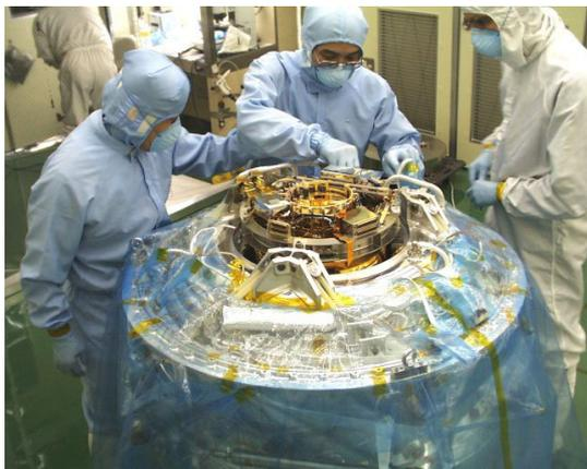
図 2.4: ASTRO-E に搭載された半導体カロリメータ (*XRS*) 用 ADR。中央の He insert の中に ADR の中心部となる salt pill がある。
