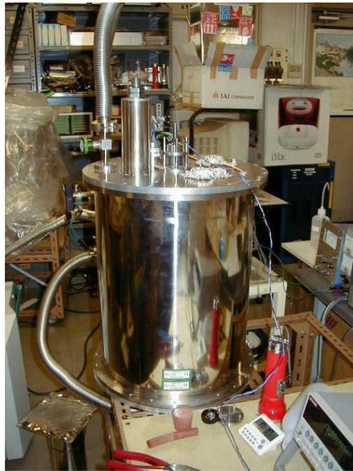
図 2.3: 断熱消磁冷凍機 — ADR(*Adiabatic Demagnetization Refrigerator*)
