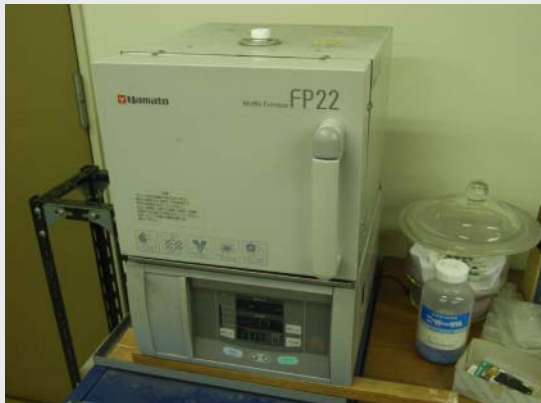
アニーリングに使用した電気炉
