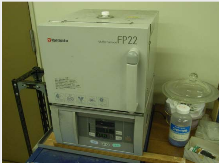
アニーリングに使用した電気炉
