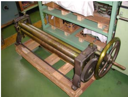
図 2.3: 曲げ機—3本のローラーからなっていて手前の2本のローラーで奥に送り、奥のローラーに当てることで曲げる
