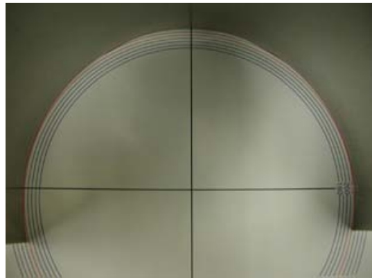
図 2.5: マスク口を開けてから曲げたもの—曲率が内側と外側で異なるのがわかる
