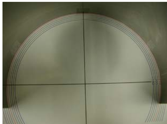
図 2.6: マスク口を開ける前に曲げたもの—曲率が内側と外側でほぼ同じである
