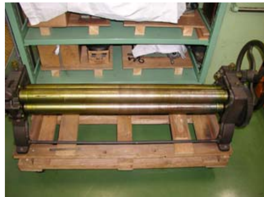
図 2.3: 曲げ機—3本のローラーからなっていて手前の2本のローラーで奥に送り、奥のローラーに当てることで曲げる
