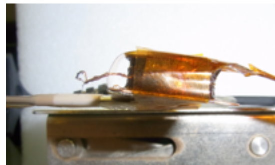
図3 ホール素子校正試験の実験セットアップの写真
